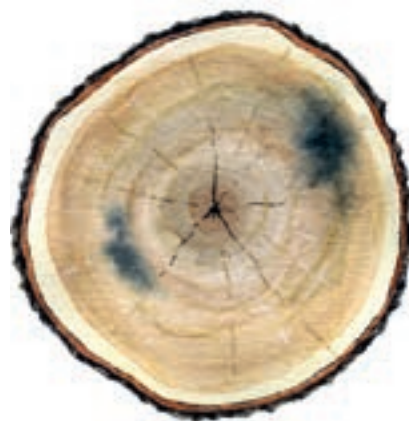
Metallskada. De blå/svarta fläckarna tyder på metallskada, om så är fallet vrak.
