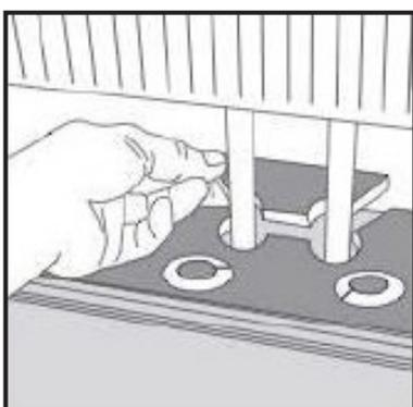
Müssen Rohrdurchführungen ausgeführt werden, müssen Sie Löcher in das Element bohren. Der Lochdurchmesser muss mind. 10mm größer sein, als der Rohrdurchmesser (2x5mm). Schneiden Sie anschließend das der Wand zugewandte Stück in leichter Trapezform aus und kleben Sie dieses Stück anschließend wieder ein.
