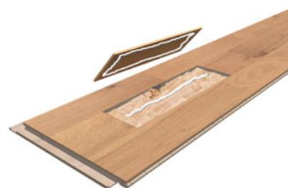
Choisir une frise de remplacement et la positionner. Remplir la cavité avec du mastic à base de polyester et appuyer sur la frise.
