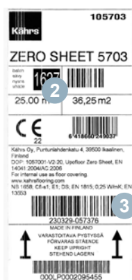
Beispiel Etikett auf der Bahnenware Zero Sheet mit (1) Farb-, (2) Chargen- und (3) Rollen-Nr.
