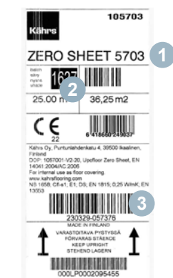
Beispiel Etikett auf der Bahnenware Zero Sheet mit (1) Farb-, (2) Chargen- und (3) Rollen-Nr.
