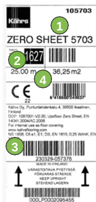
Beispiel Etikett auf der Bahnenware Zero Sound mit (1) Farb-, (2) Chargen- und (3) Rollen-Nr., (4) Rollenlänge und Menge.
