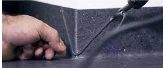
Nach dem vollständigen Erkalten der Schweißnaht wird die Schweißschnur eben abgestoßen.
